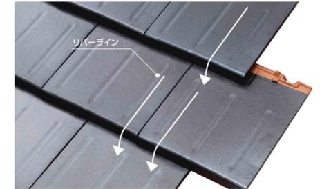
瓦の表面のリバーラインが水の流れを分け、瓦の継ぎ目からアンダーラップへの雨水の流れを防ぎます。
