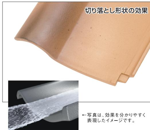
先端のエッジを立てた切り落とし形状が、流れ落ちる雨水を蹴飛ばして、逆流を起こさせません。
