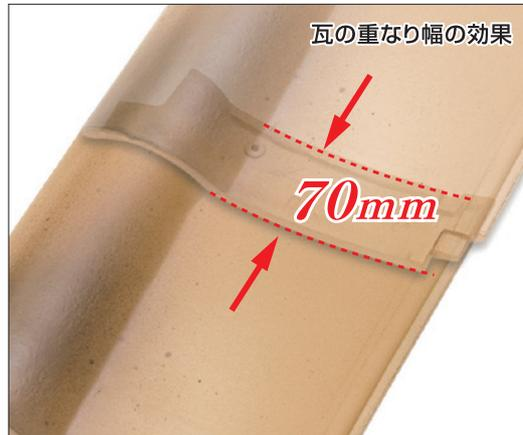
上に重なる瓦の重ね幅が70mmあります。下の瓦に水が流れる際に懸念される、水の巻き込み(逆水)を大幅に軽減させ、雨漏りを起こしにくい構造となっています。
