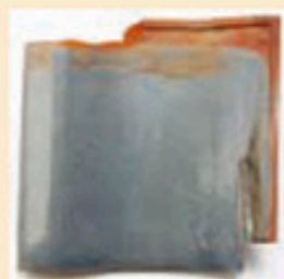
[塩害の影響で崩壊が進んだ瓦]
