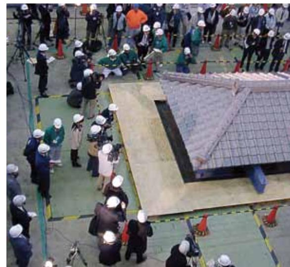
ガイドライン工法で施工されたJ形、F形の屋根の耐震実験。
