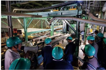
丸窓の2階建ての工場内では、オートメーション化された大がかりな設備で石州瓦が生産されていく。ここ第1工場では主に和瓦と平板瓦を生産している、熱を効率良く活用するため、1階に焼成炉、2階に乾燥炉を配置している
